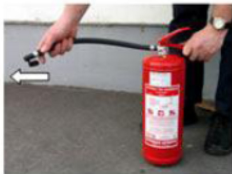
Cev usmerimo proti požaru
